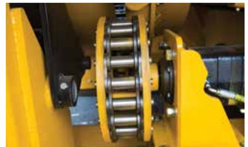
**TRANSMISIÓN DEL TAMBOR.** Un sistema de transmisión hidráulica por cadena permite que el tambor salga del diente para realizar mantenimiento. Las ruedas dentadas empernadas se pueden cambiar rápidamente y permiten reducir los costos de reparación.
