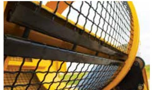
**CRIBAS TENSADAS.** Con la capacidad de tensar la criba alrededor del tambor, los operadores pueden aumentar la rigidez de las cribas. Este diseño permite el uso de un alambre de calibre pequeño, lo que finalmente aumenta el área abierta de la criba para mejorar la productividad.
