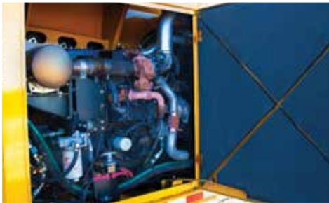
**MOTOR.** La TR620 cuenta con un motor Cummins QSB 3.3l Tier 4i (Etapa IIIB), de 90 kW (120 hp). El motor está montado en un chasis giratorio que oscila en 30 grados para un acceso superior al filtro de aceite y al depósito hidráulico para mantenimiento y servicio.
