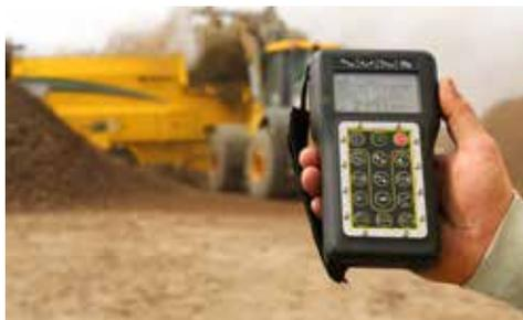
**SISTEMA DE CONTROL.** Los operadores pueden controlar la máquina a través de la pantalla DP10 de Vermeer, montada en el panel de control, o a través de un transceptor remoto portátil. Desde cualquiera de los controles, el operador puede elegir de cuatro ajustes predeterminados programables o ajustar sobre la marcha según el material entrante.
